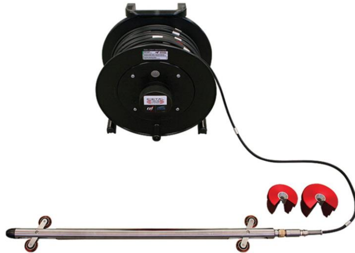
Şekil 4.4. RST inklinometre veri toplama cihazı (rstinstruments.com)
