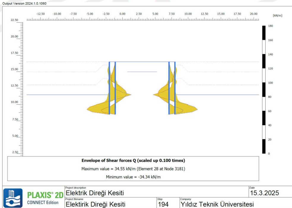
Şekil 4.31. Elektrik direği bölgesi konsol mini kazıklı geoteknik modelde mini kazıklara etkiyen maksimum kesme kuvveti
